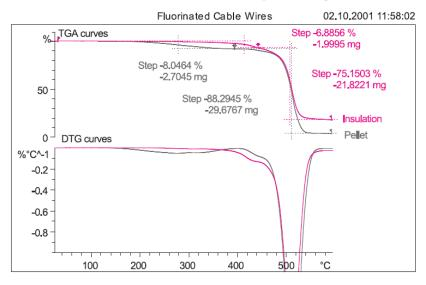
解释 ETFE 基材料的分解呈现两 个失重台阶。颗粒几乎完全分解, 只留下了3.6%的残余物。绝缘材 料的残留重量为21.2%,这说明其 含有填料。
