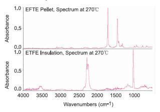
解释 两个样品的组分和分解行为 是明显不同的。绝缘材料第一个失 重(在 270℃的 DTG 峰)显示了腈 基(2300 cm<sup>-1</sup> ~ 2200 cm<sup>-1</sup>)的存在, 1025 cm<sup>-1</sup>处较强的吸收带是由于卤 代烷键C-F的存在。然而颗粒样品 第一个失重峰对应的光谱在 1450 cm<sup>-1</sup>和 1750 cm<sup>-1</sup>显示了烷基醛的吸 收带。
