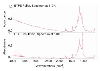
**解释** 第二个失重台阶(510℃的 DTG 峰)期间记录的 IR 光谱表明 氟化烷(1500 cm<sup>-1</sup> ~1000 cm<sup>-1</sup>)的 存在。绝缘材料光谱在 1025 cm<sup>-1</sup>
